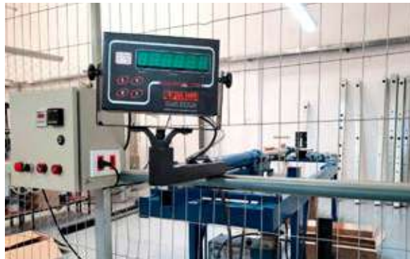
Ensaio mecânico de resistencia à flexão Flexion resistance testing Ensayo de resistencia a la flexión
