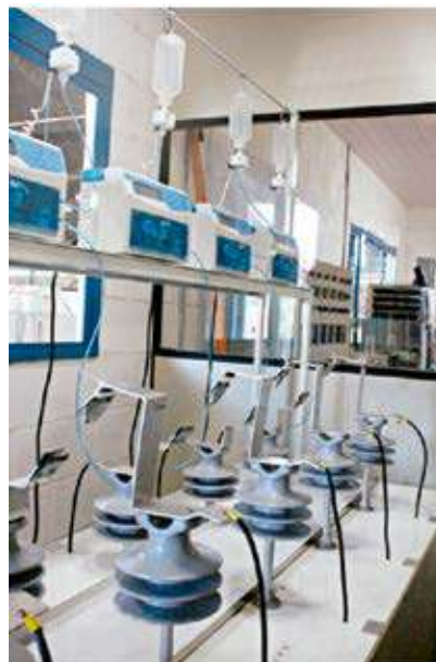
Ensaio de trilhamento elétrico (NBR 10296) Eletrical tracking testing (NBR 10296) Ensayo de "tracking" (NBR 10296)
