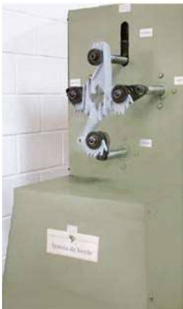
Ensaio de torção em espaçadores Spacer's torsion testing Ensayo de torsión en espaciadores
